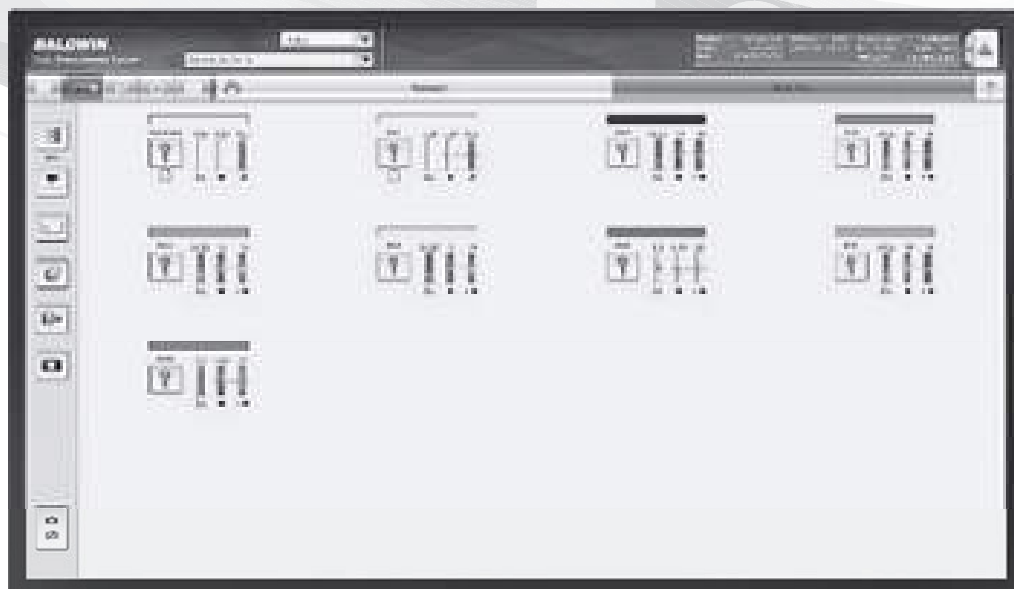
図1 メイン画面。ターゲットに対する \Delta E 、濃度誤差、ドットゲイン誤差を表示。 色による状況表示バーの表示 ・許容範囲内を緑で表示 ・許容範囲内ではあるが許容値に近いところを黄色で表示 ・許容範囲外を赤で表示
