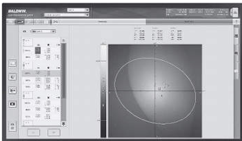
図2 特定ユニットの詳細画面 ・画面左： \Delta E 、濃度誤差、ドットゲイン誤差 ・画面右上：ターゲット値 ・画面右下：ターゲットに対する色のズレ量と方向（ab方向） ・画面真中：ターゲットに対するL方向のズレ
