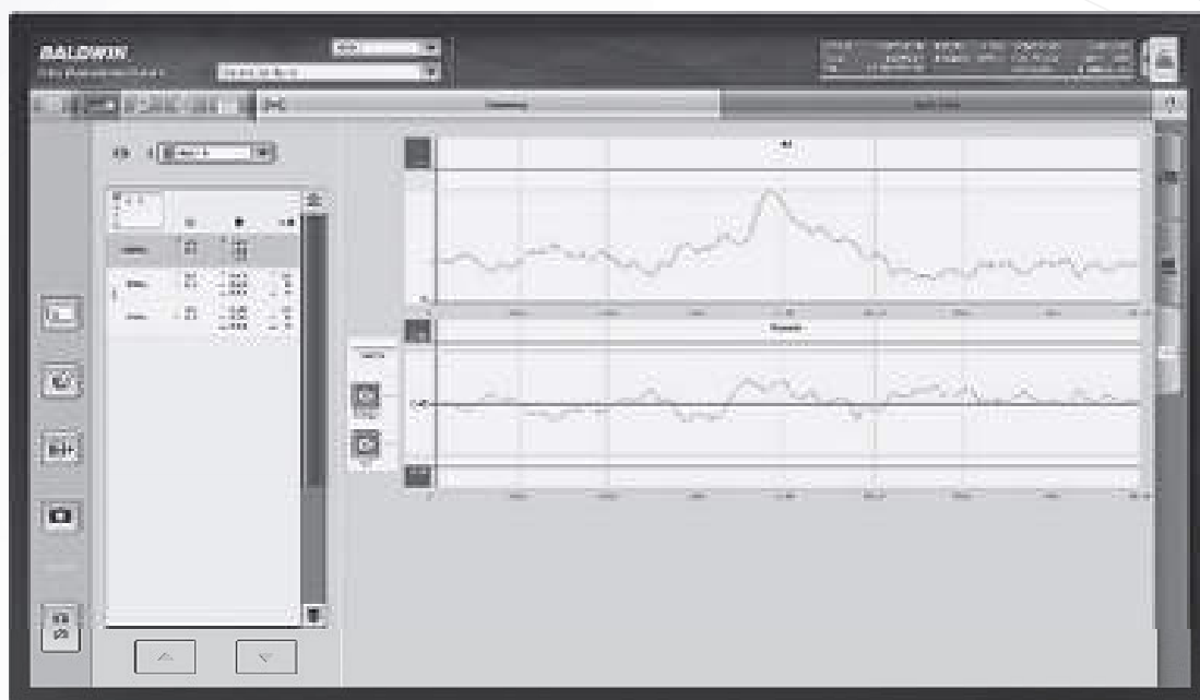
図3 トレンド画面。ユニット毎に切り替えて印刷中の色差 \Delta E 、濃度差の変化を印刷の進捗に合わせてグラフで表示。基材のジョイント部も表示する
