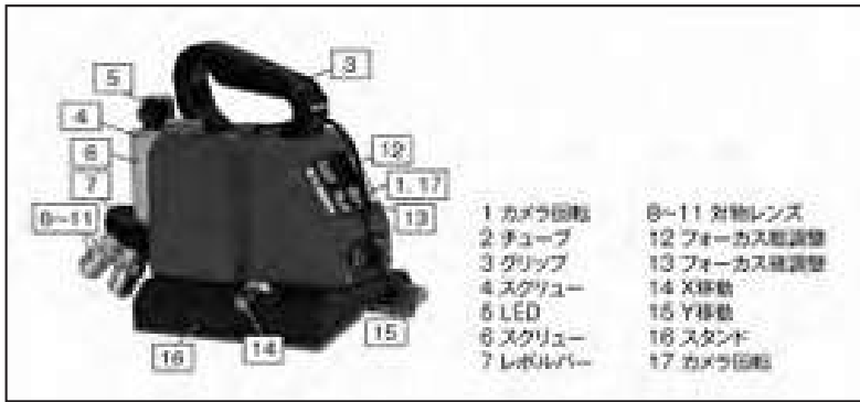
写真15 Check Master の本体と各部の機能
