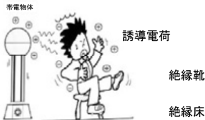
帯電物体と絶縁状態の作業着
